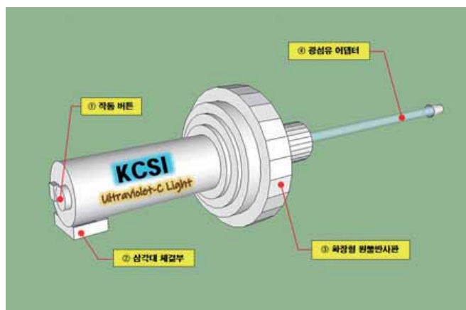
그림 9. 감식현장에서 요원들이 휴대를 하며 사용할 수 있게 만든 휴대용 UVC 조사장비
